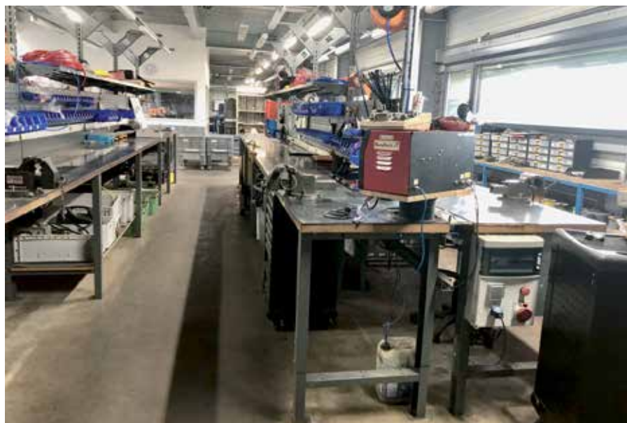
L'atelier de réparation des torches s'appuie sur trois techniciens et est équipé de quatre tables de 8 ou 12 mètres, avec des rallonges. Chaque torche est testée avant et après réparation.
